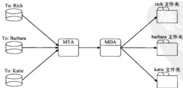
图25-2 在邮件服务器上使用MDA程序
